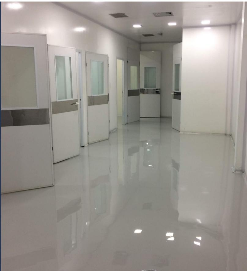
**O**s Revestimentos de Alto Desempenho (RAD) possui elevada resistência à ação mecânica/química, é monolítico, impermeável, apresenta excelente aderência sobre concreto, elevada resistência abrasiva e a impacto, apresenta diversas tonalidades de cores, é de fácil limpeza, entre outros benefícios.
